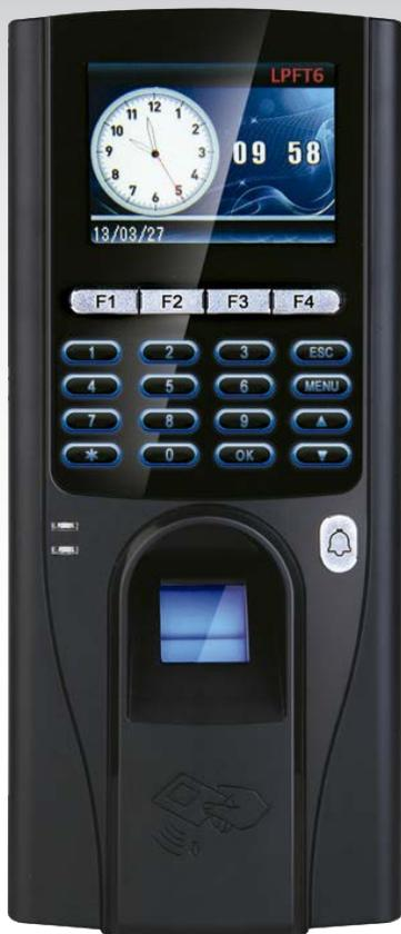
LPFT6 es un terminal de control de presencia y control de horarios ideal para Pymes. Incluye un sensor biométrico para huella dactilar así como un lector interno de tarjetas de proximidad 125Khz. Muy económico, el LPFT6 es muy fácil de poner en marcha: se suministra con fuente de alimentación y dispone de un conector TCP/IP para integrarlo en la red ethernet de la empresa.
