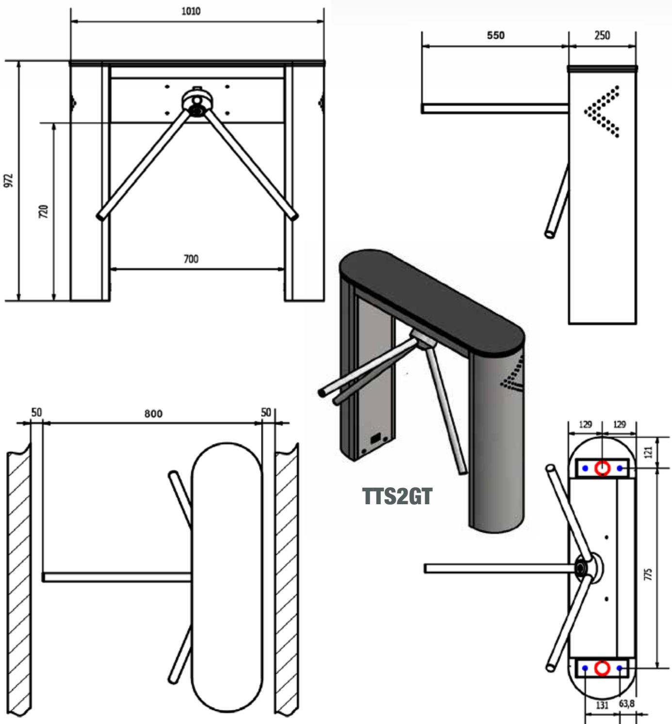
ATTENTION LORS DE LA PRÉPARATION DES SOLS ET/OU COULAGE DE LA DALLE BÉTON qui servira de support au tourniquet, prévoir l'arrivée des fourreaux au droit des cercles rouges. Fourreaux diamètre 32mm maximum, idéalement l'un pour la connexion électrique, l'autre pour le raccordement au réseau Ethernet et éventuellement câbles de signal en cas de système de commande extérieur, non intégré dans le tourniquet.
